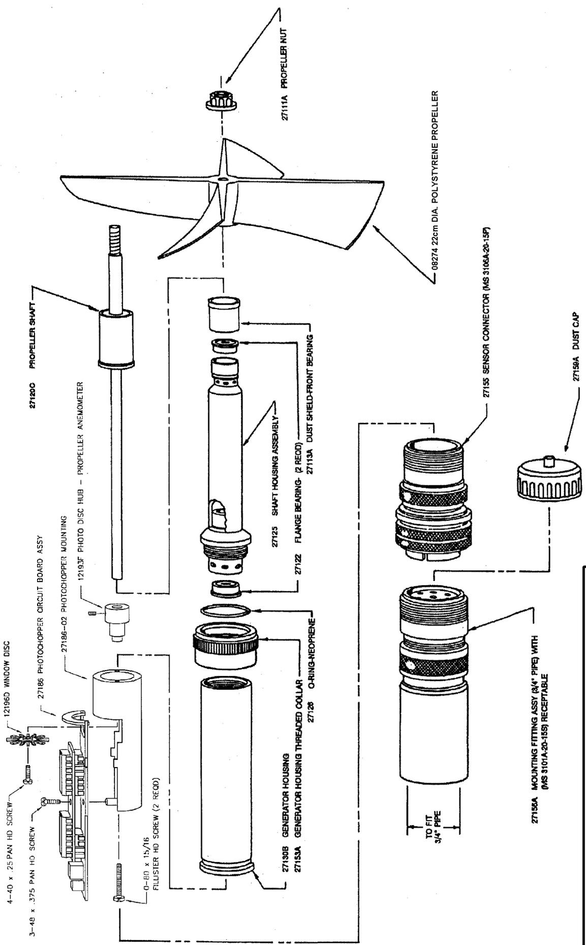
**GILL PROPELLER ANEMOMETER**
